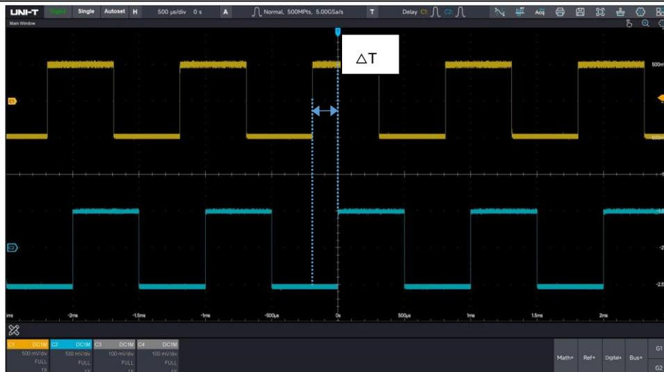
Die Flanke 1 wird auf eine steigende Flanke gesetzt, die Flanke 2 wird ebenfalls auf eine steigende Flanke gesetzt.  $\Delta T$  bezeichnet den Bereich, der in der obigen Abbildung blau markiert ist.
