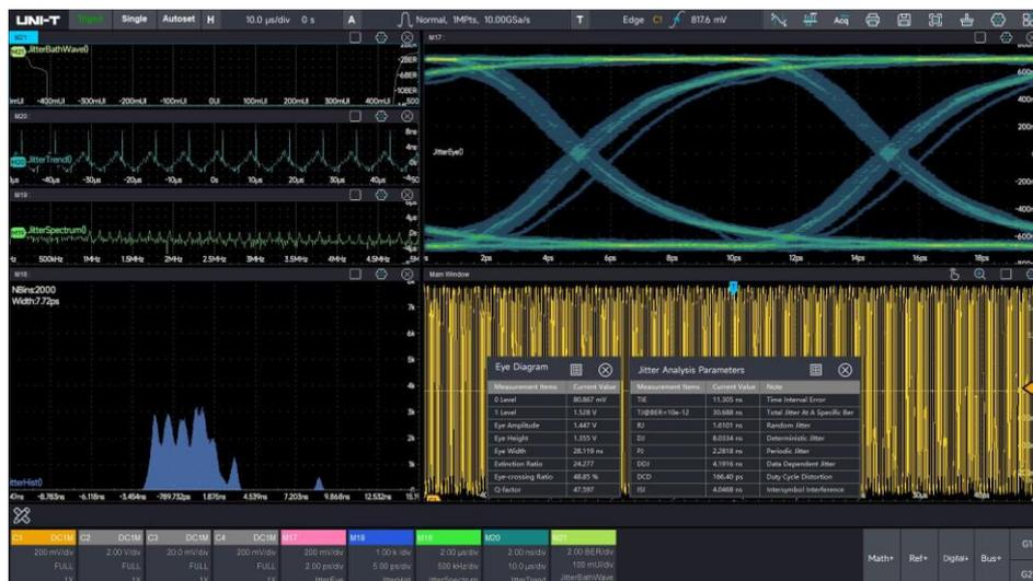
TIE (Time Interval Error) ist der Zeitfehler des Signals relativ zum Referenztakt. TIE ist Jitter in digitalen Hochgeschwindigkeitssystemen, TIE in diesem Oszilloskop bezieht sich auf  $TIE_{Peak-Peak}$ . Die Flanke des gemessenen Signals wird mit der idealen Flanke verglichen, die durch die Taktrückgewinnung ermittelt wird, und alle Signalintervalle werden entsprechend der idealen Datenrate gemessen.
