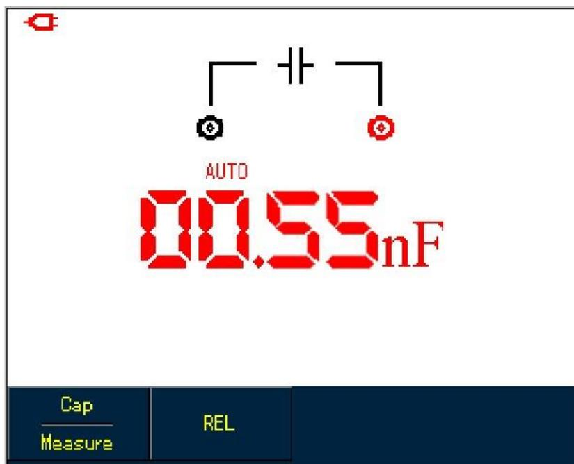
Abbildung 5-22 Messung der Kapazität im relativen Modus
