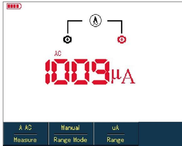
Abbildung 5-10 Messen eines Wechselstroms unter 4 mA Um einen Wechselstrom von weniger als 400 mA zu messen, gehen Sie wie folgt vor:
