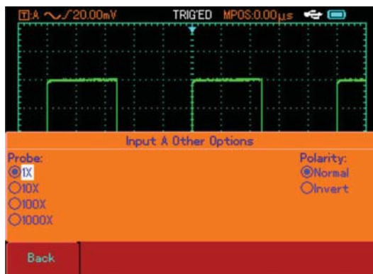
Figura 1-4 Ajuste de la relación de la sonda
