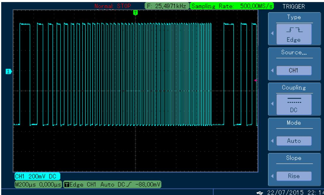
Abbildung 4- 132 Beobachtung der Frequenzsweep-Wellenform mit dem Oszilloskop
