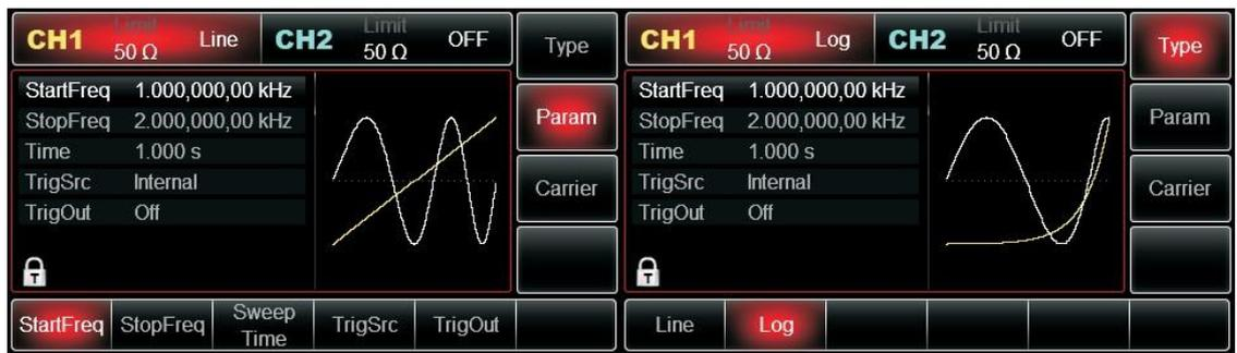
Abbildung 3 - 35 Logarithmischen Frequenzsweep auswählen
