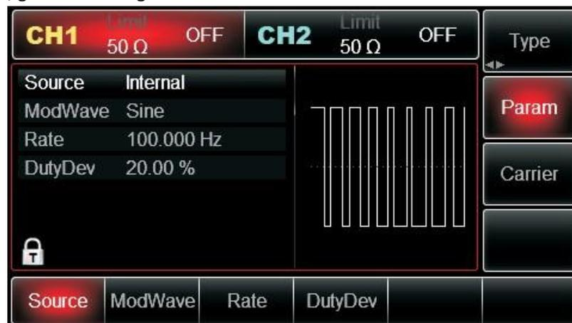
Abbildung 3 -24 Modulationsparameter einstellen
