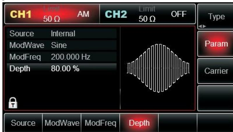
Die Form der AM-Modulationswellenform, die mit dem Oszilloskop überprüft wurde, wird wie folgt dargestellt:
