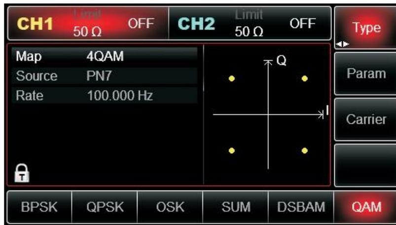
Abbildung 3 -14 QAM-Funktion auswählen
