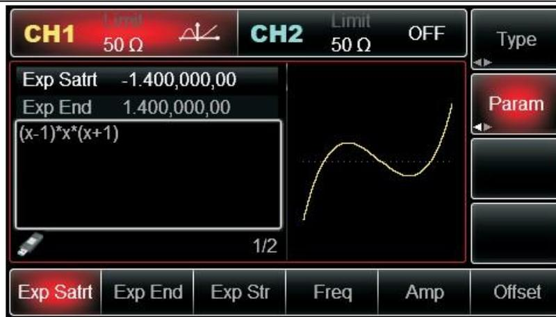
Die Ausgabe der Signalquelle ist ein Duplikat des Signals innerhalb eines begrenzten Zeitraums. Daher ist es notwendig, den Bereich der Variablen im Ausdruck  $f(x)$  zu definieren. Der Bereich von  $x$  wird durch **Initial value** und **End value** bestimmt. Drücken Sie **Initial value**, um diesen Parameter zu aktivieren. Verwenden Sie die Tastatur zur Eingabe von 1.4rad, die Einheit kann ° oder rad sein, die Schnittstelle ist wie unten dargestellt:
