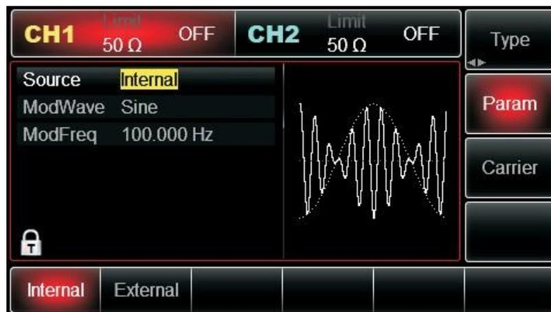
Abbildung 3 - 10 Modulationsquelle auswählen
