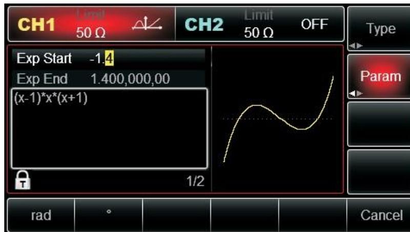
Dieses Gerät unterstützt 18 Arten von Betriebsfunktionen. Geben Sie einen Ausdruck in die Schnittstelle zur Ausdrucksbearbeitung ein und drücken Sie auf Weiter, um das Funktionssymbol oder den Ausdruck zu wechseln. Wenn Sie zum Beispiel  $(x-1) * x(x+1)$  eingeben, sieht die Schnittstelle wie folgt aus:
