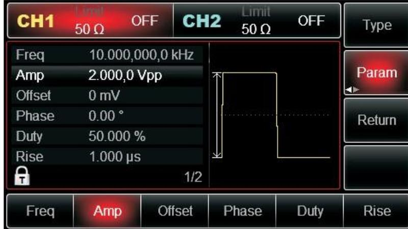
Abbildung 3 - 26 Steigende Flanke setzen
