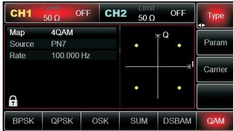
Abbildung 3 -14 QAM-Funktion auswählen
