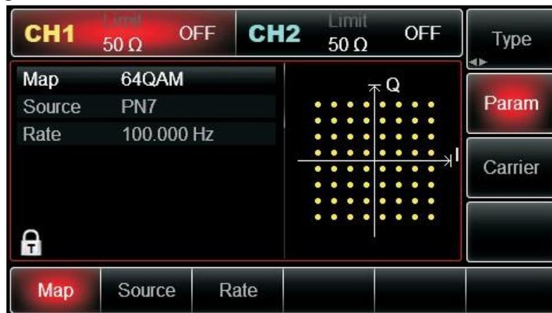
Prüfen Sie die Form der QAM-Modulationswellenform mit dem Oszilloskop, wie in der Abbildung unten gezeigt:
