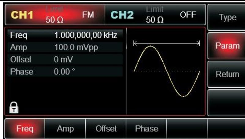
Wenn Sie die Trägerwellenfrequenz einstellen müssen, lesen Sie den Abschnitt Trägerwellenfrequenz einstellen Modulationsquellenauswahl.
