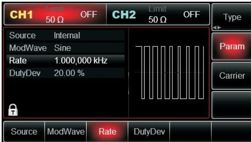
Abbildung 3 - 27 Modulationsparameter einstellen
