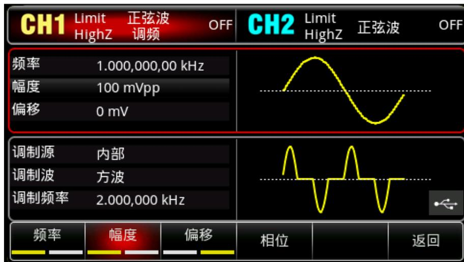
Drücken Sie den Softkey **Freq**, um die Frequenz einzustellen, geben Sie über die numerische Tastatur 10 ein und wählen Sie dann die Einheit des Parameters **kHz**.
