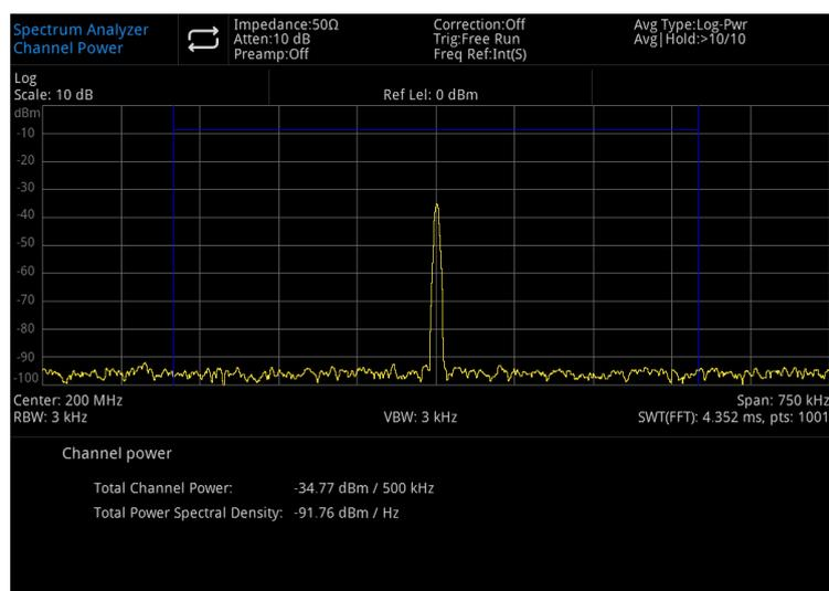
Abbildung 5-1 Kanalleistung
