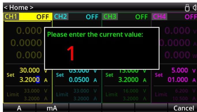
Abbildung 4-2 Bearbeitung des Stroms über das Tastenfeld
