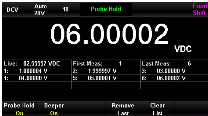
Abbildung 4-10 Menü zur DCV-Halten-Messung
