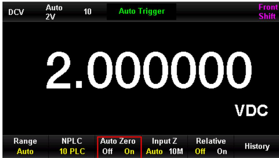
Abbildung 2-5 Automatische Nullstellung
