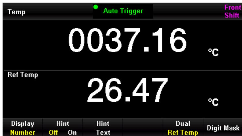
Abbildung 4-13 Duale Anzeige der Temperaturmessung, Menü 1
