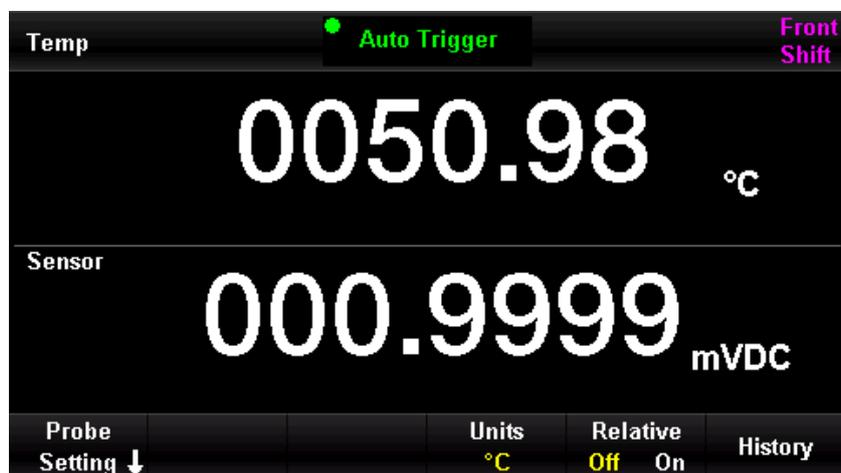
Abbildung 4-142 Duale Anzeige der Temperaturmessung, Menü 2
