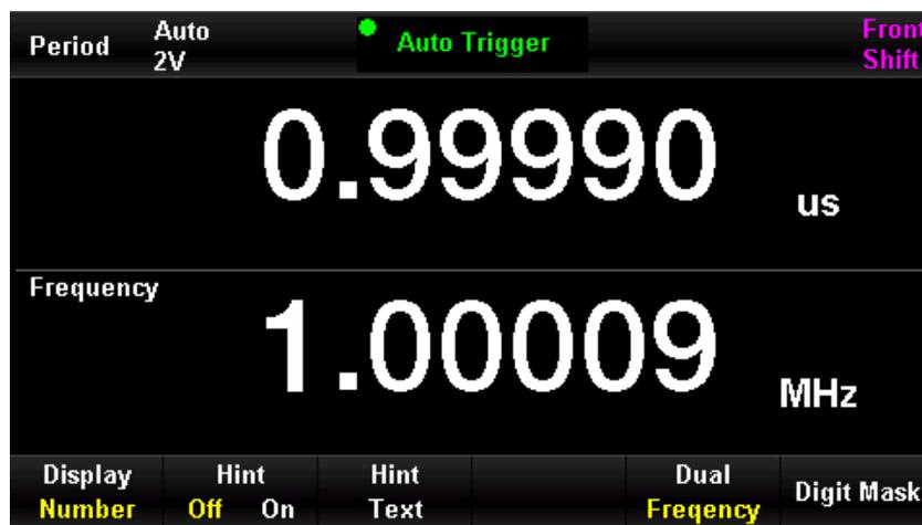
Abbildung 2-544 Duales Display (z.B. primäre Frequenz, sekundäre Periode)
