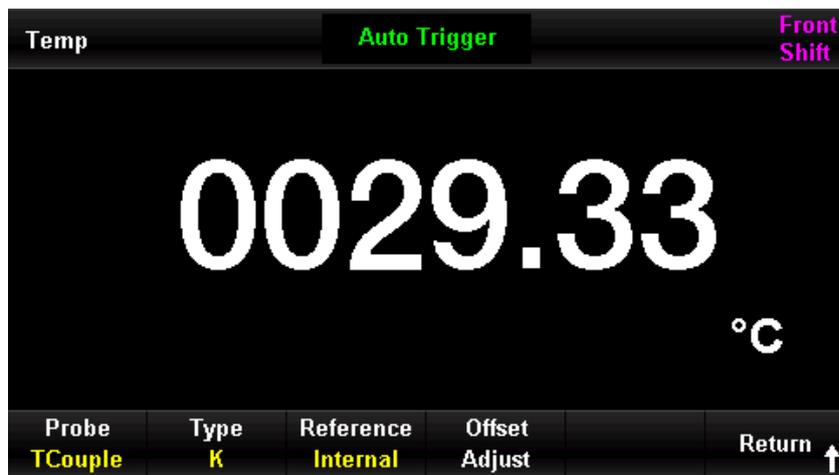
Abbildung 4-12 Menü zur Temperaturmessung mit Thermoelement Typ K
