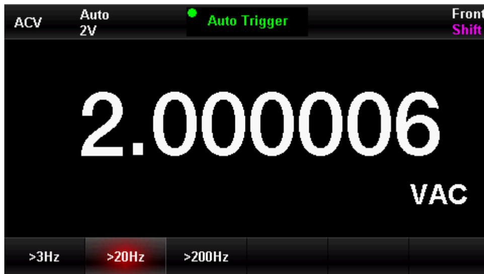
Abbildung 2-6 Einstellung des Niederfrequenzfilters
