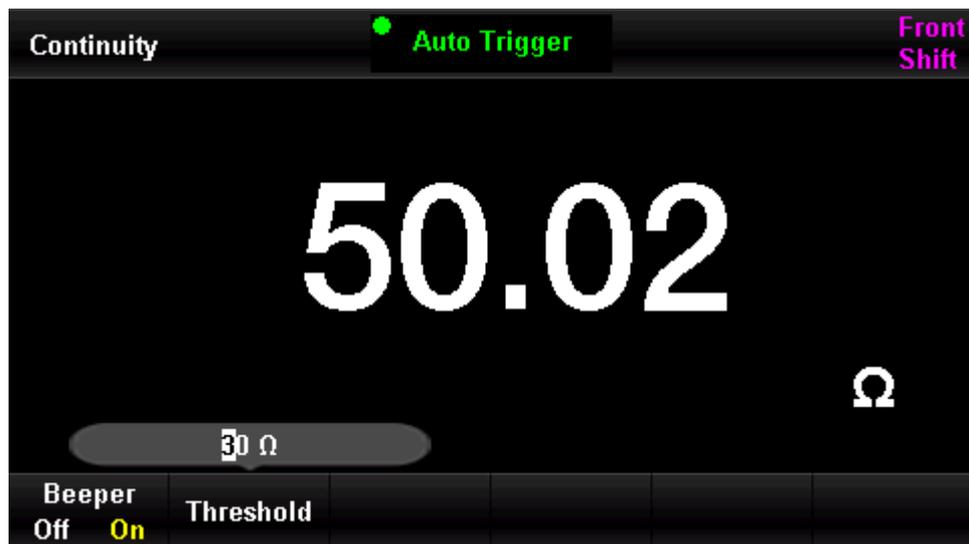
Abbildung 2-7 Einstellung des Kurzschlusswiderstandes
