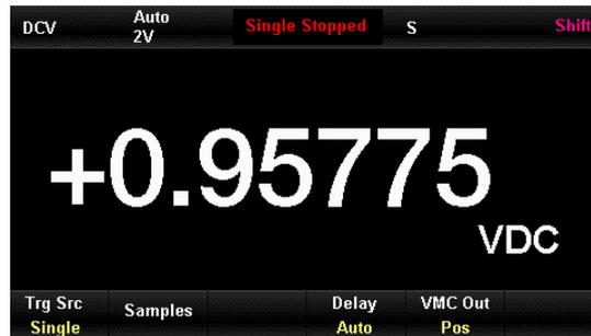
Abbildung 2-38 Schnittstelle für Einzeltrigger einstellen
