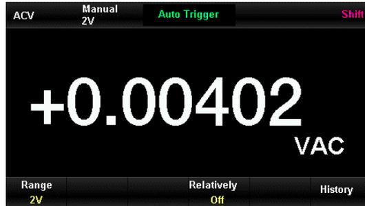
Abbildung 2-8 Schnittstelle der Wechselspannungsmessung
