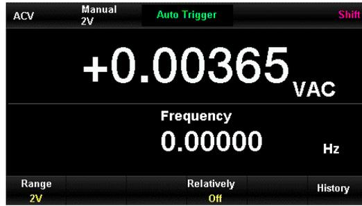
Abbildung 2-10 Schnittstelle für Wechselspannungs- und Frequenzmessung
