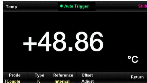
Abbildung 3-12 Temperaturmessung mit einem Thermoelement vom Typ K
