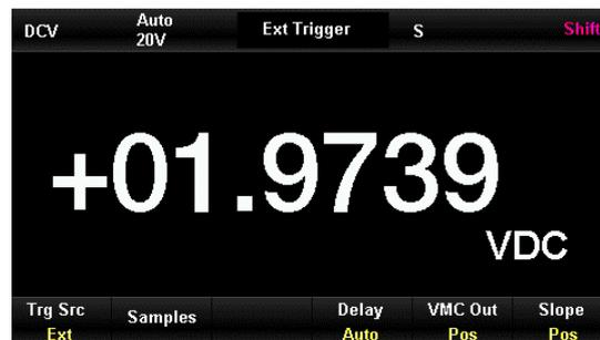
Abbildung 2-39 Schnittstelle für externen Trigger einstellen
