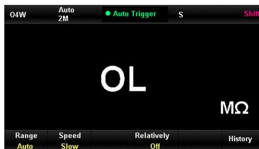
Abbildung 2-15 Schnittstelle der 4-Draht-Widerstandsmessung
