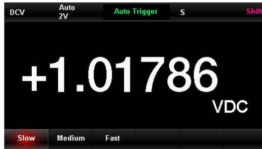
Abbildung 2-3 Schnittstelle zur Auswahl der Messgeschwindigkeit
