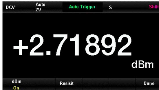
Abbildung 2-44 Schnittstelle des dBm-Betriebs
