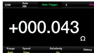
Kurzschluss-Messleitungen Abbildung 3-4 Ablesung
