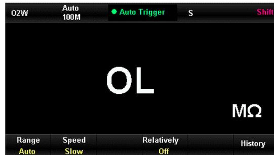
Abbildung 2-13 Schnittstelle 2-Draht-Widerstandsmessung
