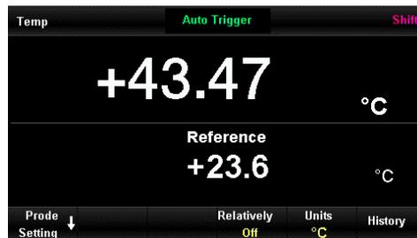
Abbildung 3-13 Duale Anzeige der Temperaturmessung
