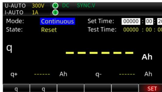
2. Wählen Sie den Integrationsmodus "Kontinuierlich" oder "Normal", indem Sie die Taste **[◀]** oder **[▶]** drücken.
