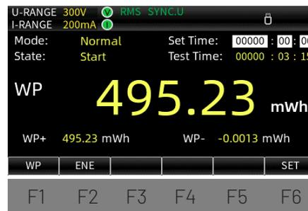
1. Drücken Sie in der Integrationsschnittstelle die Taste „F1“, um zur Leistungsintegration WP oder zur Stromintegration q zu wechseln.
