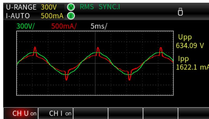
CH U<sub>on</sub> : enable the voltage waveform display
