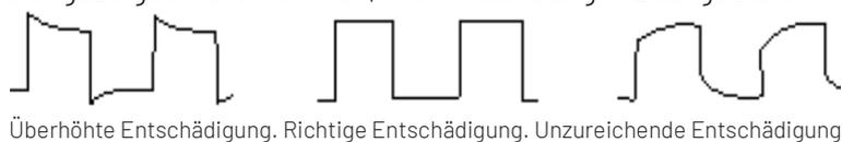
Abbildung 4-2 Kompensierende Kalibrierung der Sonde
