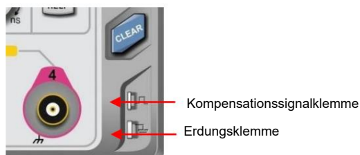
Abbildung 1 Kompensationssignal und Erdungsanschluss
