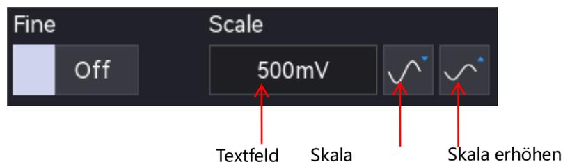
Die MSO3000HD-Serie unterstützt die vertikale Einstellung. Im Menü "Kanaleinstellung" kann die Einstellmethode auf "Grobabstimmung" oder "Feinabstimmung" eingestellt werden. "EIN" bedeutet Grobabstimmung, "AUS" bedeutet Feinabstimmung. Die Standardeinstellung ist Grobabstimmung. Drücken Sie den vertikalen Skalendrehknopf auf der rechten Seite des Bedienfelds, um zwischen "Grobabstimmung" und "Feinabstimmung" umzuschalten.
