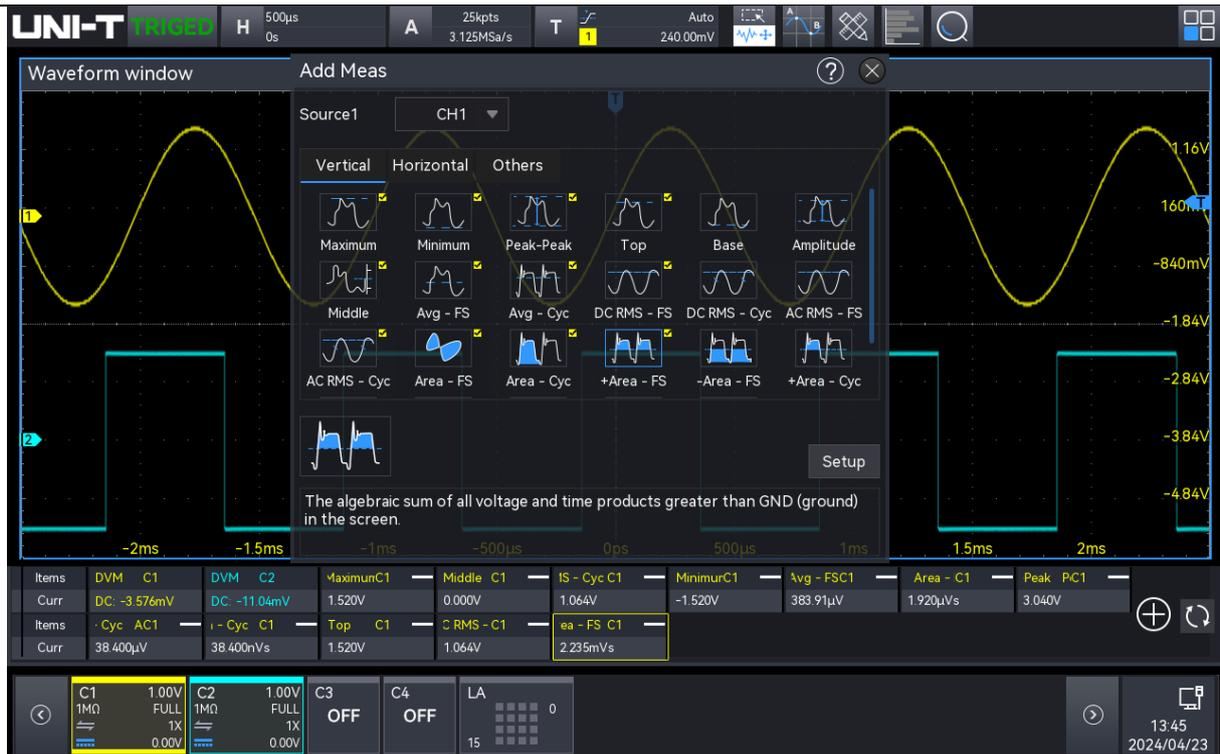
Die Parametermessung wird oberhalb der Volt/Div-Infobox angezeigt, die den Messparameter und den aktuellen Wert anzeigt. Während der Messung wird der Zähler und das Voltmeter standardmäßig ganz links angezeigt, und die benutzerdefinierten Parameter folgen dahinter. Die Parametermessung unterstützt die Einstellung von bis zu 27 Parametern.
