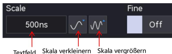
Die MSO3000HD-Serie unterstützt die horizontale Einstellung. Im Menü "Kanaleinstellung" kann die Einstellmethode auf "Grobabstimmung" oder "Feinabstimmung" eingestellt werden. "EIN" bedeutet Grobabstimmung, "AUS" bedeutet Feinabstimmung. Die Standardeinstellung ist Grobabstimmung. Drücken Sie den horizontalen Skalendrehknopf auf der rechten Seite des Bedienfelds, um zwischen "Grobabstimmung" und "Feinabstimmung" umzuschalten.
