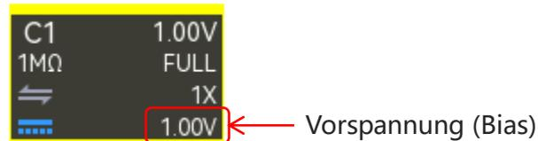
Wenn CH1 aktiviert ist, kann der vertikale Offset mit den folgenden Schritten eingestellt werden.
